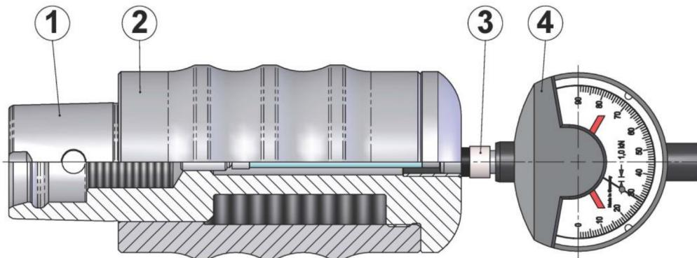
**HINWEIS!** Der Dehnbolzen ist als Kegel ausgeführt. Eine Polygonform ist zur Messung nicht erforderlich.
